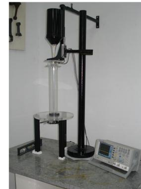
**Flujo y presión en silos.** El flujo de un material granular al descargarse de un silo difiere mucho del flujo de un fluido así como sucede con la presión sobre paredes y fondo. Se estudia este fenómeno mediante experimentos y simulación.
