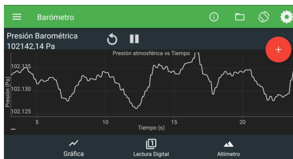
Figura 16: Ejemplo de lectura de presión con la aplicación Physics Toolbox
