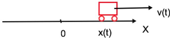
donde  $x(t) \geq 0, v(t) = \frac{dx(t)}{dt} \geq 0$ , o sea el móvil puede estar a la derecha o izquierda del origen y puede moverse acercándose o alejándose del mismo. Es importante recordar, que usando la interpretación la derivada,  $v(t)$  nos dá la pendiente de la curva  $x(t)$  en un dado tiempo con lo cual podemos mediante la inclinación determinar el signo de la velocidad.
