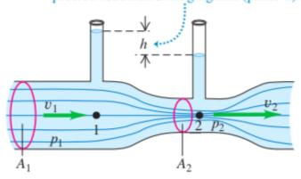
Si planteamos Bernoulli a una línea de corriente entre 1 y 2, usamos la ecuación de continuidad y la diferencia de alturas medida en los tubos de Venturi tendremos
