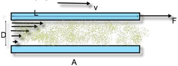
y comprobariamos que es proporcional al área , a la velocidad e inversamente proporcional a la separación, siendo el coeficiente de proporcionalidad el llamado coeficiente de viscosidad  $\eta$
