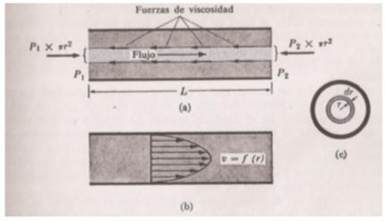
y si consederamos un tubo imaginario de radio r y longitud L con eje en el centro del tubo que se nueve a velocidad constante v(r) tendremos que las fuerzas de presión deben equilibrar a las viscosas
