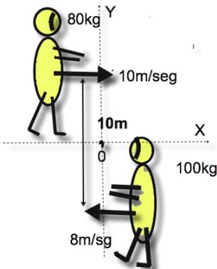
La velocidad del CM debe ser constante pues la fuerza neta externa es cero y la cantidad de movimiento del sistema  $\mathbf{P} = M\mathbf{V}_{CM}$  debe mantenerse constante. Tomemos el eje x con origen en el punto medio de ambas trayectorias iniciales y paralelo a ellas y sentido positivo hacia la derecha, con esto
