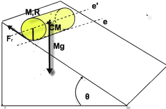
Nos encontramos aquí con un elemento nuevo, la fuerza de roce por rodadura que es diferente a la de deslizamiento. Sin entrar en detalles sobre esta fuerza lo importante es que el punto de contacto siempre estará debajo del eje de rotación alrededor del CM con lo que es desplazamiento del punto de contacto sobre el cilindro será el mismo que lo que se desplace el CM o sea  $ds = V_{CM}dt \Rightarrow ds/dt = v_T = V_{CM} = R\omega$ .
