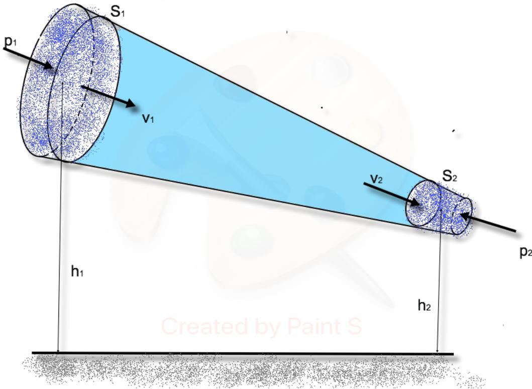
Aislemos imaginariamente un tubo de fluido de pequeñas secciones a lo largo de una línea corriente. Si una porción de fluido es desplazada  $\Delta x_1$  en un punto 1 por las fuerzas de presión, se desplazará  $\Delta x_2$  en un punto 2 debido a un posible cambio en la sección de las tubería, y se realizará un trabajo de las fuerzas de presión externas ( $F = pS$ )
