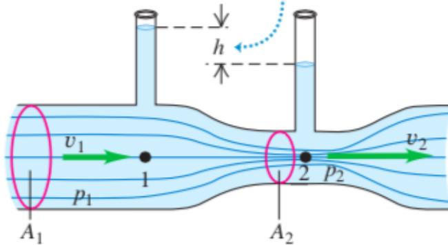
Si planteamos Bernoulli a una línea de corriente entre 1 y 2, usamos la ecuación de continuidad y la diferencia de alturas medida en los tubos de Venturi tendremos
