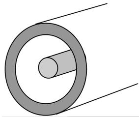
14. Un cilindro no conductor, de longitud infinita y radio  $R$  tiene una distribución de carga  $\rho(r) = ar$ .
