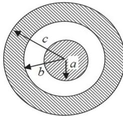
13. Un cable largo y recto se rodea con un cilindro metálico hueco cuyo eje coincide con el del cable. El cable tiene una densidad lineal de carga  $\lambda$ , y el cilindro tiene una densidad lineal de carga neta  $2\lambda$ .
