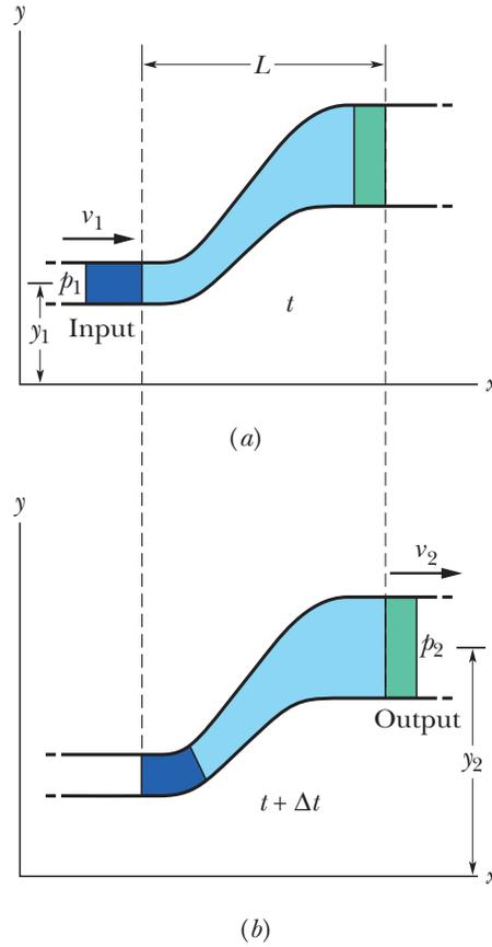
Figura 5: Un fluido fluye a razón constante a través de una longitud  $L$  de un tubo, desde la entrada de la izquierda hasta la salida a la derecha. Del tiempo  $t$  en (a) a  $t + \Delta t$  en (b), entra una cantidad de fluido del lado izquierdo (en azul) y la misma cantidad sale del lado derecho (en verde).
