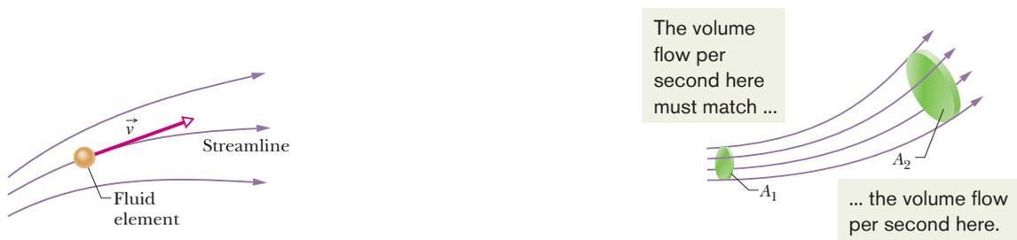
Figura 2: En la primera figura, un elemento del fluido traza una línea de flujo a medida de que se mueve, siendo su velocidad, tangente a la trayectoria. En la segunda figura, se define al tubo de flujo, a partir de las líneas de flujo que forman su contorno.
