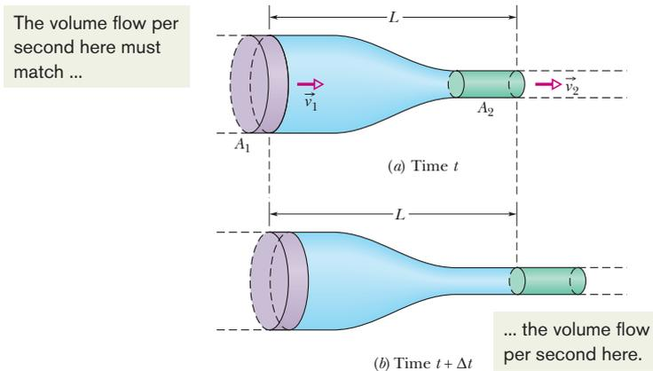
Figura 3: el fluido fluye de izquierda a derecha a una razón constante a través de un tubo de longitud  $L$ . La rapidez del fluido es  $v_1$  en el lado izquierdo y  $v_2$  en el lado derecho. La sección transversal de área es  $A_1$  en el lado izquierdo y  $A_2$  en el derecho. Del tiempo  $t$  en (a) al tiempo  $t + \Delta t$  en (b), entra una cantidad de fluido del lado izquierdo (en violeta) y la misma cantidad sale del lado derecho (en verde).
