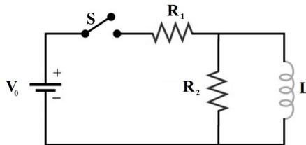
2. En el circuito del problema anterior, suponga  $V_0 = 6\text{ V}$ ,  $R_1 = 5\ \Omega$  y  $R_2 = 1\ \Omega$ . Luego de haber estado cerrado por un tiempo muy largo, se abre el interruptor y la corriente disminuye hasta el valor de  $0,25\text{ A}$  al cabo de  $0,15\text{ s}$ . ¿Cuál es el valor de la inductancia?
