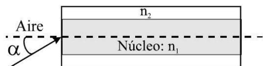
la luz incidente desde el aire no escape del núcleo y pueda, de ese modo, propagarse por la fibra.
